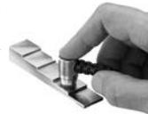
2. Placer le plat de la sonde sur la surface. Appliquer une pression modérée pour appuyer sur la partie supérieure de la sonde avec le pouce ou l'index.
