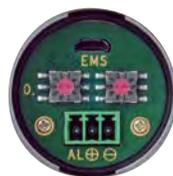
Thermalert 4.0 2-Fils. Alimentation et sortie analogique dans la boucle de courant
