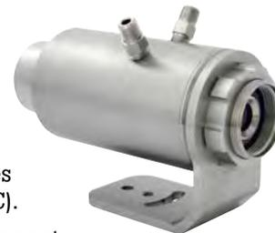
Chemises de refroidissement pour des températures ambiantes extrêmes (jusqu'à 315 °C) intégrant une purge à air et assurant de surcroît une excellente protection mécanique. Un capteur Thermalert 4.0 peut être retiré de sa chemise de refroidissement et ensuite remis en place sans altérer son alignement.
