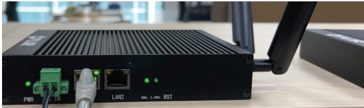
Figure 9.2 Connexion d'un câble Ethernet à la GW66.
