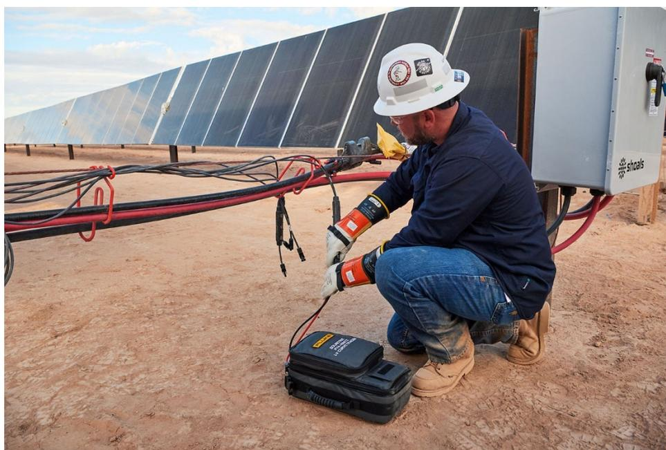
Le Fluke Solmetric PVA-1500 est un kit d'analyseur de courbe I-V de pointe conçu pour assurer une mesure précise de l'énergie et un fonctionnement optimal du système. Grâce à cet équipement de test de haute précision, vous pouvez évaluer de manière fiable l'état et l'efficacité de vos modules solaires, en prenant des décisions éclairées pour améliorer leur rendement et leur longévité.
