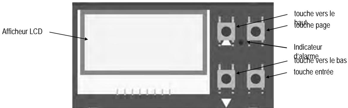
Figure 34: Panneau de contrôle du boîtier de communication (DIN)
