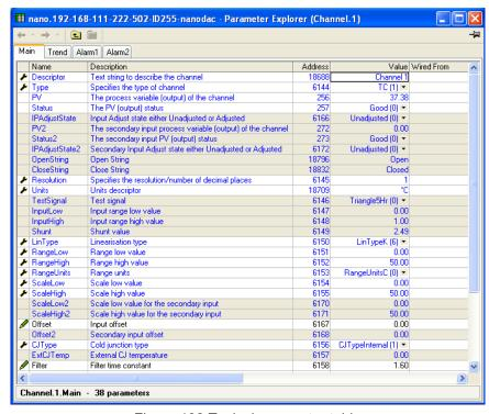
Figure 182 Typical parameter table
