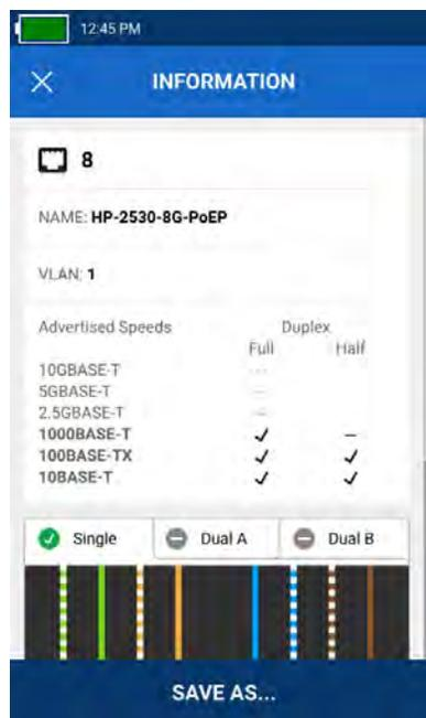
Le test de port de commutateur indique le numéro de port, le nom du commutateur et le réseau VLAN du port, ainsi que la vitesse annoncée et les paramètres duplex. Si vous défilez vers le bas, vous pouvez voir les résultats de la PoE.
