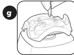
H. Chargement des tubes de 2 mL (languette de 2 tubes – 24 maximum)
