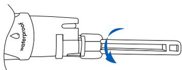
Dégagez l'électrode en utilisant la 2<sup>e</sup> partie de la clé.
