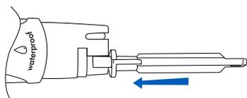
Insérez-la dans la cavité de l'électrode ainsi que le montre le schéma, tournez dans le sens inverse des aiguilles d'une montre.
