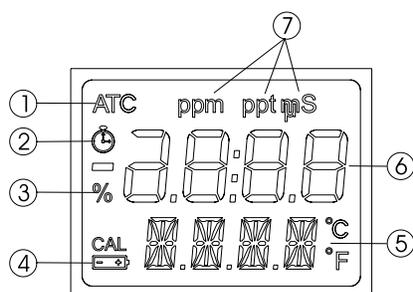
1. Indicateur de compensation automatique de température
