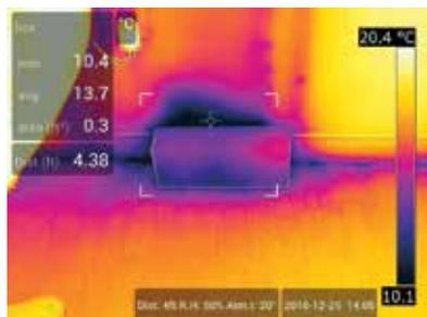
Quantifier les problèmes à l'aide de la mesure de superficie affichée à l'écran (m<sup>2</sup> ou pi<sup>2</sup>)
