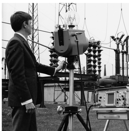
Figure 31.2 1969 : Thermovision, modèle 661. La caméra pesait environ 25 kg, l'oscilloscope 20 kg et le trépied 15 kg. L'opérateur avait également besoin d'un groupe électrogène de 220 VCA et d'un récipient contenant 10 l d'azote liquide. À gauche de l'oscilloscope, on distingue le Polaroid (6 kg).
