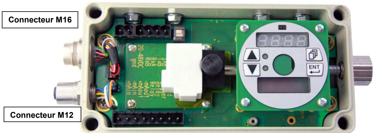
Figure 11 : Boîtier de traitement avec connecteurs M16 et M12.
