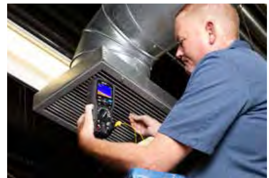
Entrée thermocouple de type K pour les mesures de température différentielle
