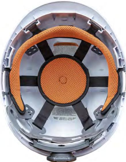
La coiffe de recharge pour casque de sécurité de Klein Tools est exclusivement compatible avec ces derniers. Elle se fixe en six points à l'intérieur de la coquille du casque de sécurité, avec un serre-nuque ouvert flexible pour une circulation de l'air maximale. Le bouton à cliquet et l'ajustement du pivot permettent un positionnement sécuritaire sur la tête. Également offerts : bandeau antisudation de recharge et coussinet sur le dessus de recharge (tous vendus séparément).
