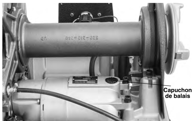
Figure 34 – Retrait du capot et remplacement des balais
