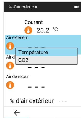
La fonction **Pourcentage d'air extérieur** offre le choix entre l'utilisation de la température ou du CO<sub>2</sub> pour l'étude du pourcentage d'air extérieur si une sonde prenant en charge soit le CO<sub>2</sub> soit la température est branchée.
