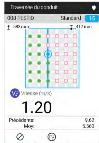
Après avoir pris une mesure de vitesse à chaque emplacement de la grille, le cheminement est terminé et vous serez invité à appuyer sur ⌂ pour accepter le cheminement. Avant d'accepter le cheminement, vous pouvez revenir en arrière et reprendre n'importe quelle mesure en naviguant jusqu'à ce point avec les touches de navigation.
