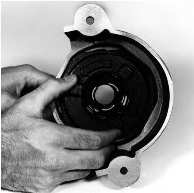
Figure 12 – Retrait du couvercle des mâchoires
