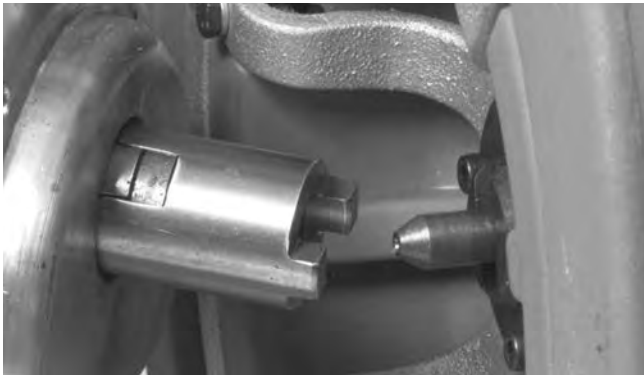
Figure 15 – Tambour K-3800 avec adaptateurs pour K-6200
