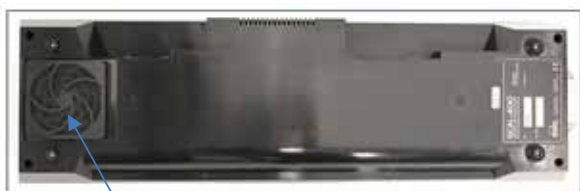
Cooling fan intake
