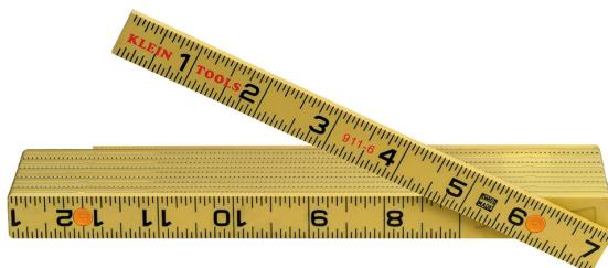
Les règles pliantes en bois de Klein Tools sont fabriquées en nylon solide renforcé de fibre de verre pour offrir une durabilité accrue et une meilleure résistance aux intempéries, à l'abrasion et à la plupart des produits chimiques. Elles présentent des mesures sur les deux côtés et les deux rebords, et des traits aux 1,6 mm (1/16 po). Des traits sont gravés des deux côtés.
