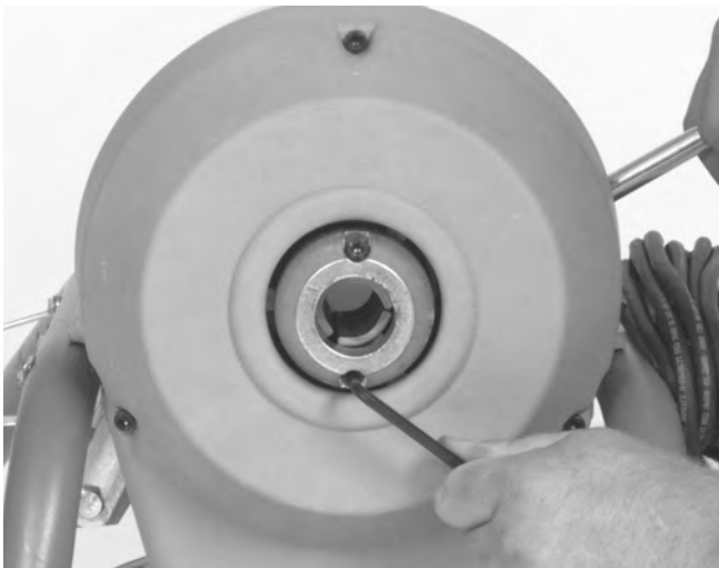
Figura 12 – Recambio de las mordazas del embrague
