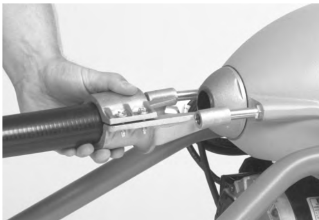
Figura 3 – Conexión de la manguera guía trasera
