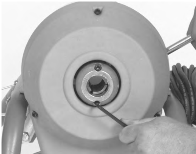
Figure 12 – Remplacement des mâchoires d'embrayage
