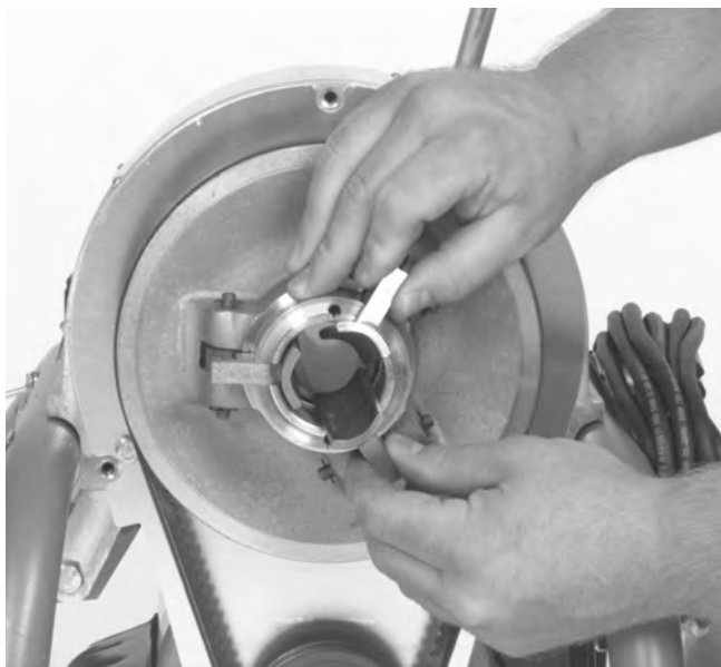
Figure 13 – Remplacement des mâchoires d'embrayage
