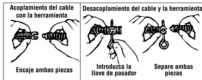
Figura 5 – Acoplamiento y desacoplamiento de herramientas
