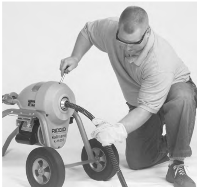
Figura 6 – Posición de trabajo correcta
