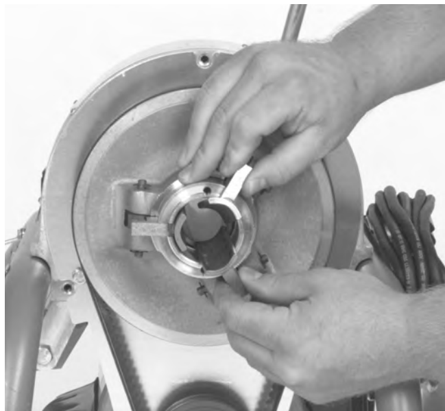
Figura 13 – Recambio de las mordazas del embrague
