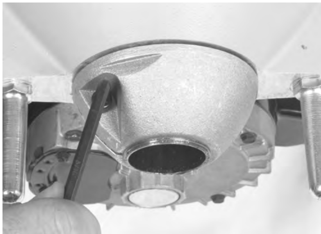
Figure 14 – Réglage de l'embrayage
