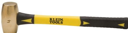
Conçu pour une utilisation dans les environnements sans étincelles, ce marteau à tête de laiton ne produit pas d'étincelles et ne marque pas, pour plus de sécurité. Le manche en fibre de verre comprend un surmoulage en caoutchouc thermoplastique pour un confort accru et une absorption des chocs. L'évasement large à la base permet d'éviter la perte de prise.
