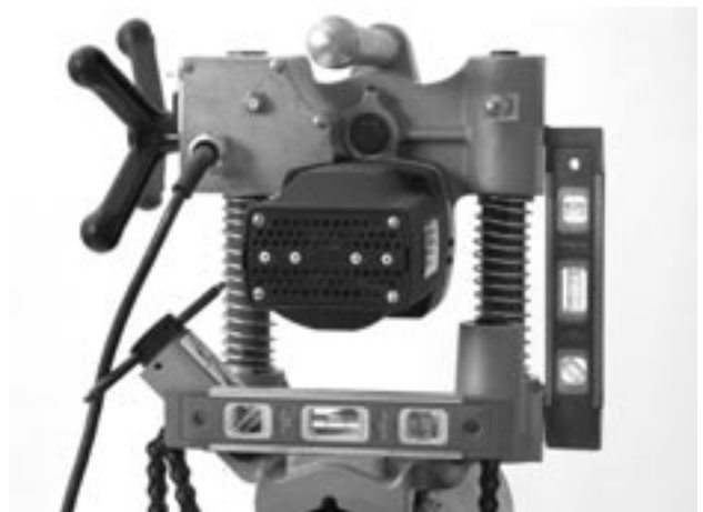
Figure 10 – Mise de niveau de la HC-300
