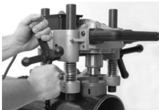
Figure 11 – Utilisation de la scie à cloche
