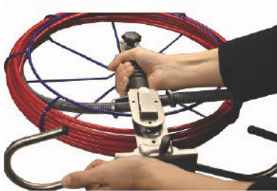
Imm. 39: Mettre en place le support de l'enrouleur (Option)
