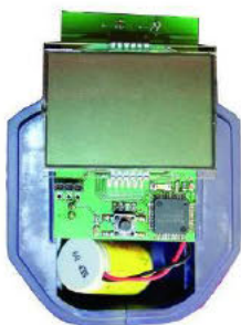
Imm. 45: Remplacement de la pile
