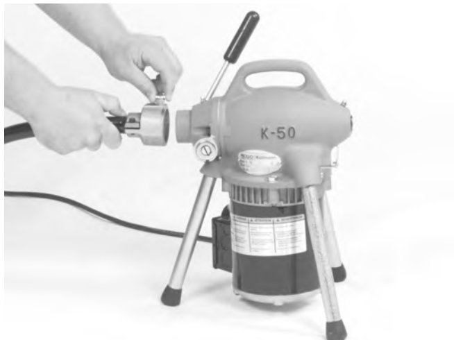
Figure 2 – Montage du guide-câble arrière
