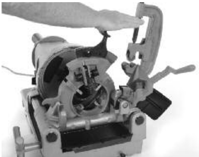
Figure 19 – Fermeture de la tête de filière rétractable
