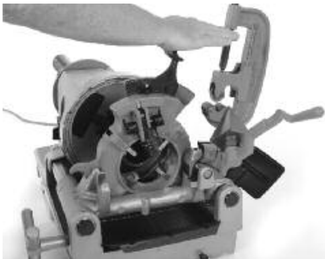
Figura 19 – Cierre del cabezal de terrajas con retroceso
