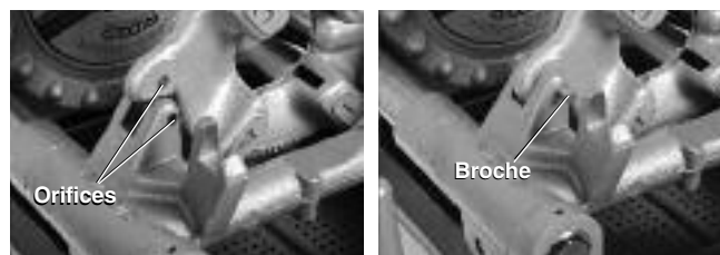
Figure 26 – Rétention de la tête de filière à gauche
