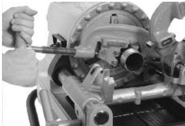
Figura 22 – Corte de un tubo con el cortador
