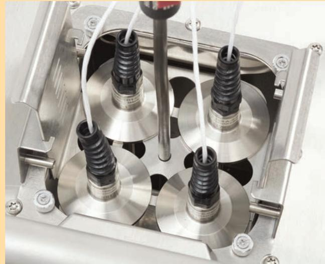
**1 Réservoir** – Le réservoir en acier inoxydable contient le liquide du bain.
