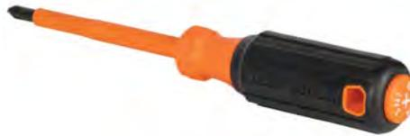
Les tournevis isolés de Klein Tools sont dotés d'un revêtement d'isolation orange vif ignifuge et résistant aux chocs qui protège contre les chocs électriques. Ces outils sont testés pour dépasser la norme ASTM F1505 pour les outils isolés et clairement identifiés par le symbole officiel de la classification « 1000 V ». Le trou de longe dans le manche offre une sécurité accrue lors des travaux en hauteur. Les tournevis sont offerts en tiges rondes de 4 po et de 6 po avec une variété de pointes.
