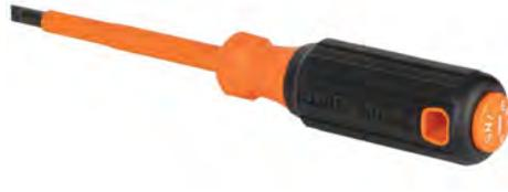
Les tournevis isolés de Klein Tools sont dotés d'un revêtement d'isolation orange vif ignifuge et résistant aux chocs qui protège contre les chocs électriques. Ces outils sont testés pour dépasser la norme ASTM F1505 pour les outils isolés et clairement identifiés par le symbole officiel de la classification « 1000 V ». Le trou de longe dans le manche offre une sécurité accrue lors des travaux en hauteur. Les tournevis sont offerts en tiges rondes de 4 po et de 6 po avec une variété de pointes.
