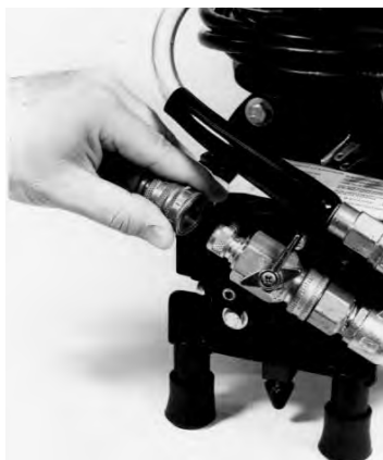
Figure 2 – Branchement du tuyau d'arrivée d'eau sur le dégorgeoir. Fermeture du robinet d'arrivée (montré en position fermée).
