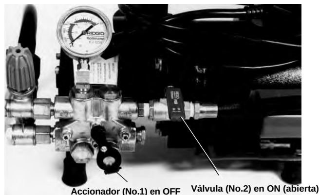
Figura 7 – Para franquear codos y sifones
