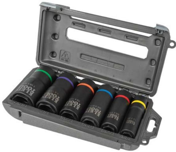
Offrant 12 tailles de douille à choc sur 6 douilles faciles à transporter, ce jeu de 6 pièces comprend les douilles à choc les plus fréquemment utilisées pour les travaux électriques et de construction. Chaque douille à choc comprend deux douilles coaxiales à ressort en une seule. La conception à 6 facettes à couple élevé se place facilement sur les dispositifs de fixation, y compris ceux carrés. Ce jeu comprend un adaptateur 1/4 po hexagonal à 1/2 po carré et un étui de transport pratique.
