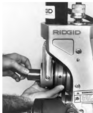
Figure 12 – Retrait de l'arbre et du galet de rainurage
