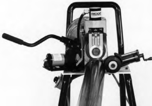
Figure 7 – Décalage du tuyau avec la 918-I (exagéré pour raisons de clarté)
