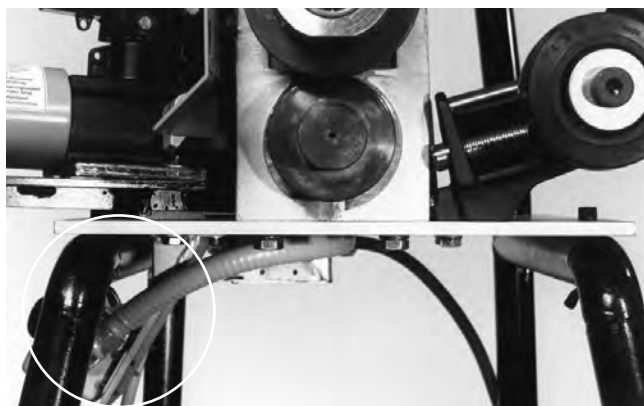
Figure 20 – Retrait de l'appareil de son support
