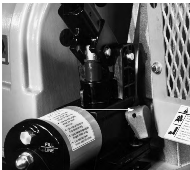
Figure 4 – Détail du levier de verrouillage de pompe de la 918-I
