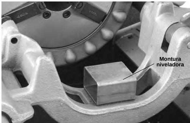
Figura 16 – Montura en el carro 535
