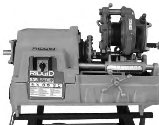
Figure 17 – Fileteuse démultipliée en montage direct avec 535
