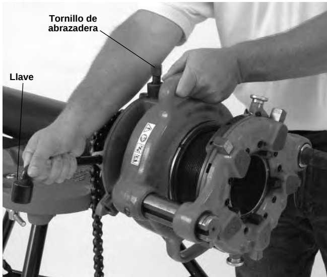
Figura 6 – Cómo apretar el portaherramientas
