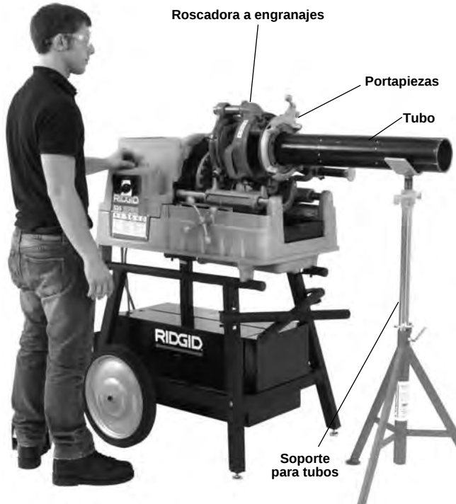
Figura 21 – Posición de operación (método de acoplamiento directo)
