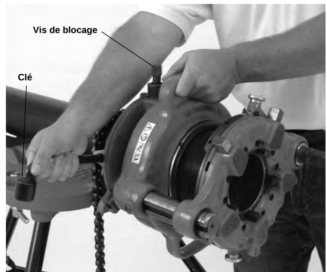
Figure 6 – Serrage de la bride de maintien
