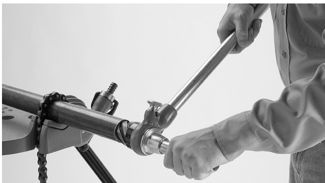
Figure 4 – Alésage de l'extrémité du tuyau
