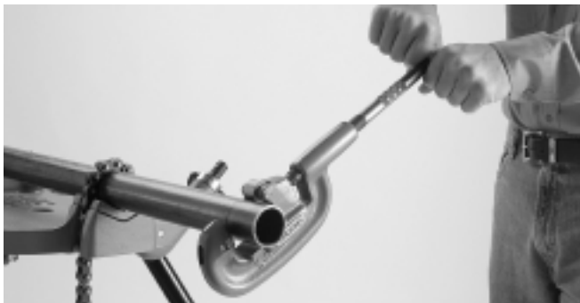
Figure 1 – Coupe de l'extrémité du tuyau
