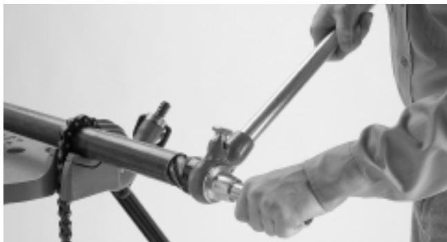
Figure 2 – Alésage de l'extrémité du tuyau
