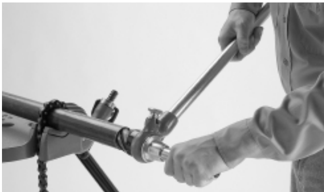
Figura 2 – Escariado del extremo del tubo
