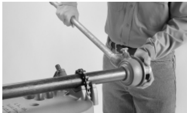
Figure 3 – Montage de la fileteuse sur le tuyau
