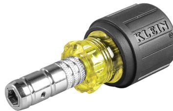
Pointe brevetée unique qui glisse de l'avant vers l'arrière pour passer d'une tête hexagonale de 1/4 po à une tête hexagonale de 5/16 po. Il suffit de visser l'écrou moleté pour verrouiller la pointe sélectionnée. L'aimant dans la tête hexagonale tient la vis en place, peu importe le tourne-écrous utilisé. Manche en caoutchouc Cushion?Grip classique pour un confort et un couple supérieurs.
