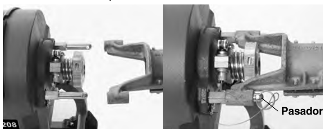
Figura 6 – Conexión de la manguera guía trasera
