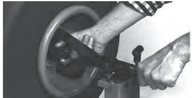
Figura 21 – Extracción de la perilla del eje central
