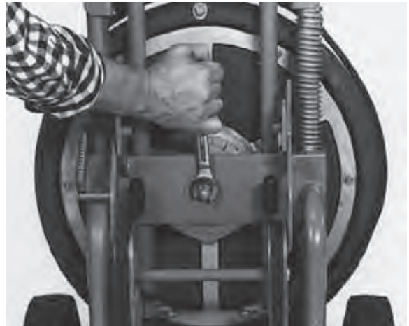
Figura 7 – Revise el perno para asegurar que se encuentra apretado
