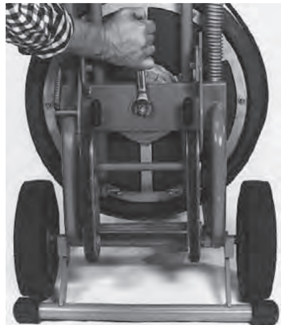
Figura 19 – Extracción del perno en el soporte trasero
