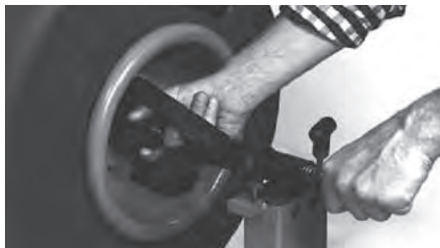
Figure 21 – Retrait de la manette de l'arbre central
