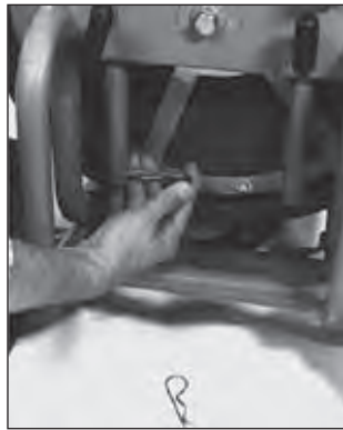
Figura 5 – Asegure el mango con las chavetas de sujeción. Apriete las dos (2) perillas en forma de T
