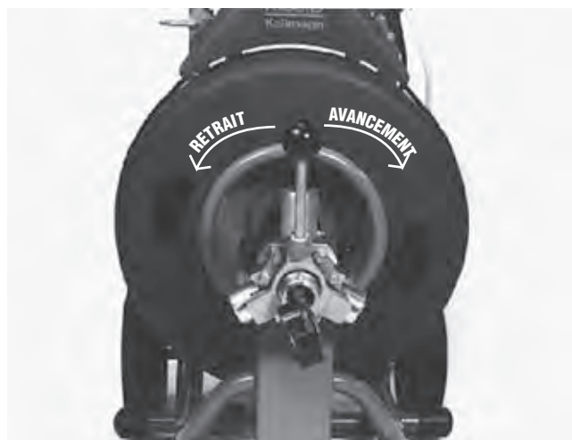
Figure 11 – Utilisation du levier d'entraînement
