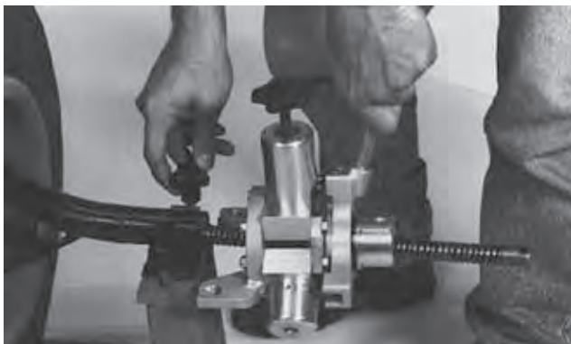
Figure 14 – Retrait du système d'entraînement AUTOFEED
