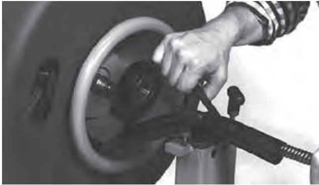
Figure 22 – Retrait du guide-câble
