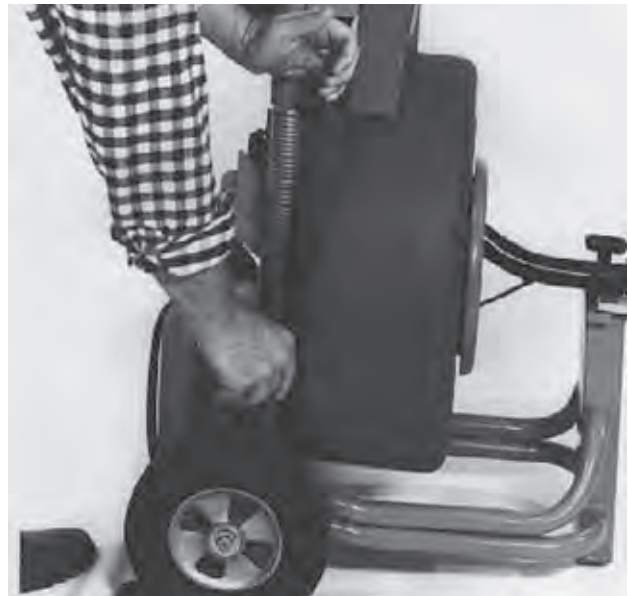
Figura 18 – Afloje la tensión de la correa
