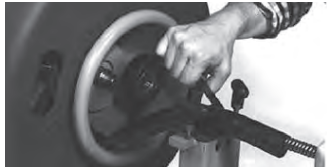
Figura 22 – Extracción del tubo guía
