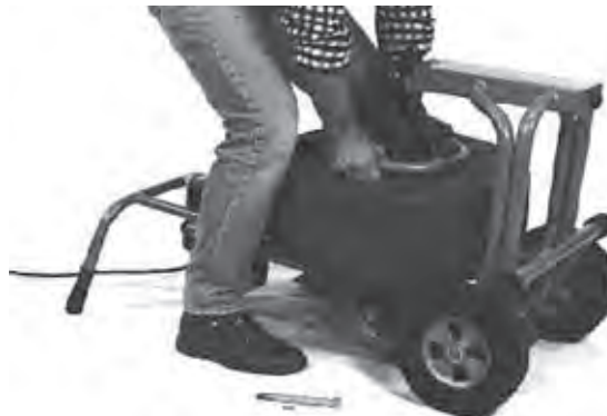
Figure 20 – Positionnement du tambour sur le cadre
