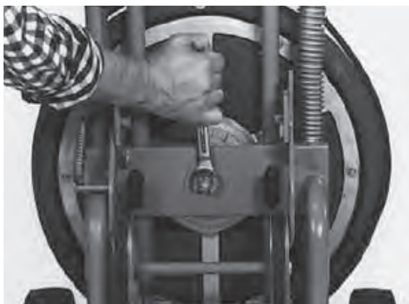
Figure 7 – Vérifiez le serrage du boulon
