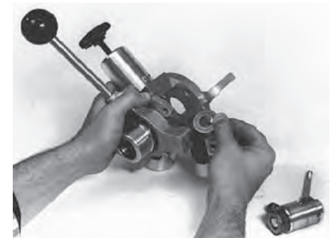
Figura 17 – Introduzca dos arandelas espaciadoras cuando emplee cable de \frac{5}{8} pulg.
