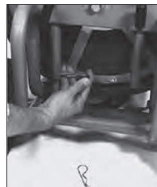
Figure 5 – Verrouillage des poignée à l'aide des goupilles. Serrage des deux (2) manettes en forme de T.
