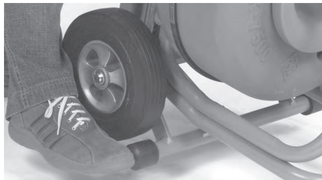
Figure 8 – Engagement de la béquille
