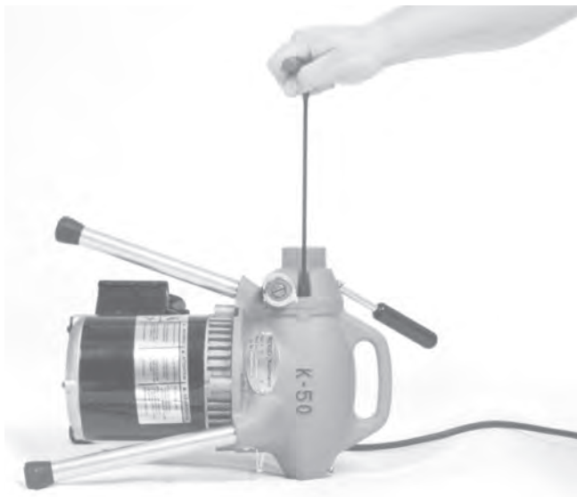
Figura 10 – Extracción de los tornillos de cabeza de cubo
