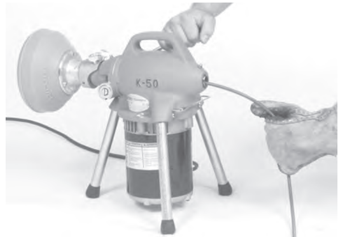
Figure 5 – Montage de l'adaptateur de câble
