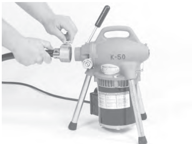
Figure 2 – Montage du guide-câble arrière
