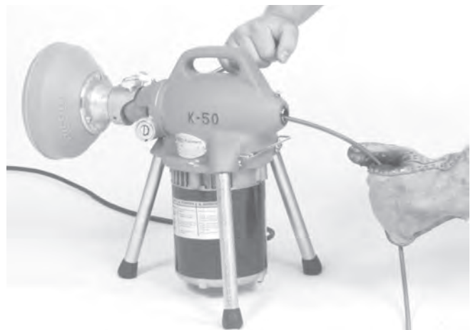
Figura 5 – Acoplamiento del adaptador para el cable
