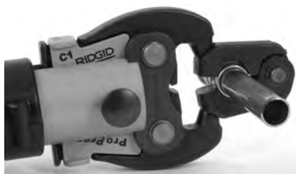
Figura 10 – Montaje del accionador en el aro sellador
