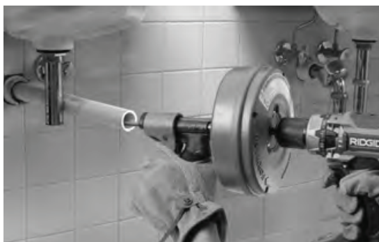
Figura 7 – Ejemplo de una extensión del desagüe para que la limpiadora quede a menos de 4 pulgadas (10 cm) de la apertura del desagüe
