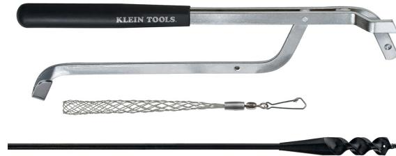
Le jeu de mèches à bois flexibles de Klein comprend tout ce dont vous avez besoin pour percer des trous et tirer des fils et des câbles. La mèche à bois flexible permet de faire des trous de 14 mm (9/16 po) dans le bois. Le guide repliable vous aide à guider la mèche lorsque vous percez un trou. Le tire-câble s'attache à la mèche flexible une fois que le trou est percé, afin de tirer des fils et câbles à travers le trou.
