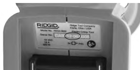
Figure 4 – Numéro de série de l'appareil – Les 4 premiers chiffres (encerclés) indiquent l'année et le mois de fabrication. (12 = année, 06 = mois).
