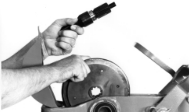
Figure 12 – Retrait du disque de tronçonneuse
