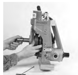
Figura 18 – Se extrae el eje de retención y el rodillo ranurador
