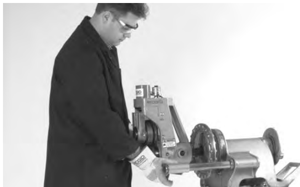
Figura 2 – Instalación del Accionamiento Propulsor No. 300
