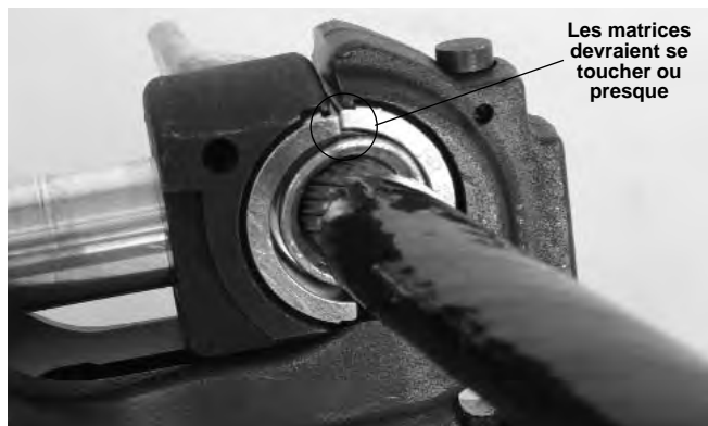
Figure 8 – Inspection des matrices lors de l'activation du clapet de détente
