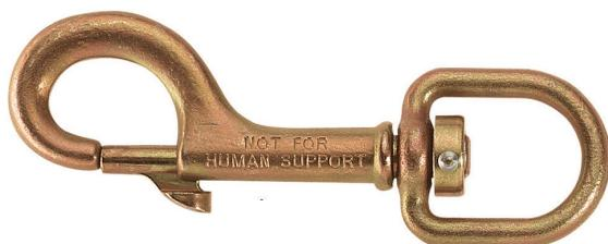
Le crochet pivotant de 1/2 po avec loquet de piston de Klein Tools est fait d'acier forgé. Il peut soutenir une charge maximale de 750 lb. L'action de pivotement du maillon permet une rotation fluide qui prévient tout enchevêtrement accidentel avec des câbles secondaires.
