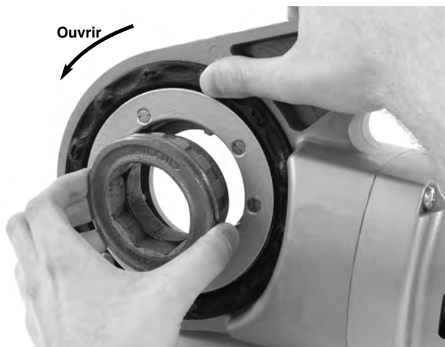
Figure 8 – Installation de l'adaptateur sur la 690-I
