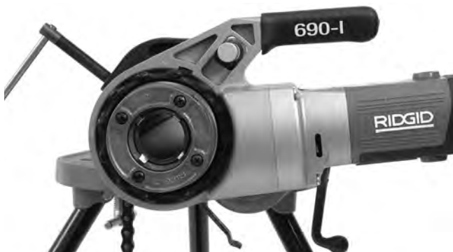
Figure 12 – Orientation appropriée du système d'entraînement
