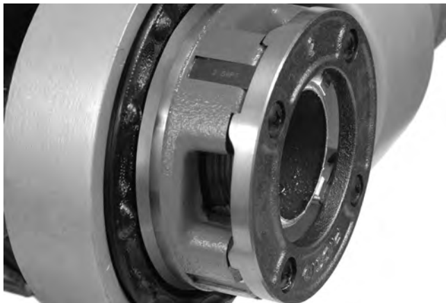
Figure 15 – Tuyau arrivé à fleur des filières
