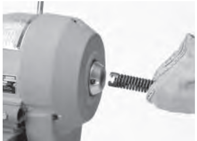
Figure 3 – Insertion du câble à l'avant de la machine
