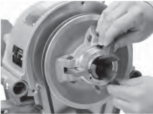
Figura 12 – Recambio de las mordazas del embrague
