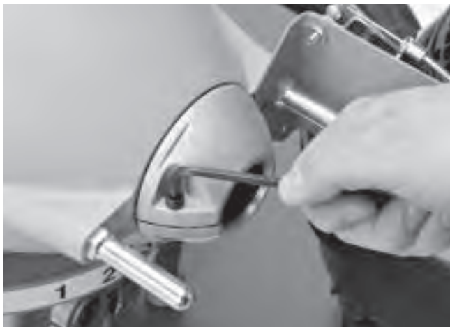
Figure 13 – Élimination du jeu axial de l'embrayage
