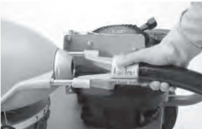
Figura 2 – Acoplamiento de la manguera guía trasera
