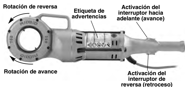
Figura 3 – Posición del interruptor para seleccionar el sentido de la rotación
