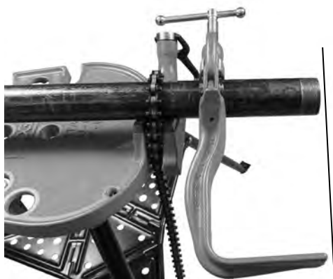
Figure 5 – Bras de support aligné sur l'extrémité du tuyau
