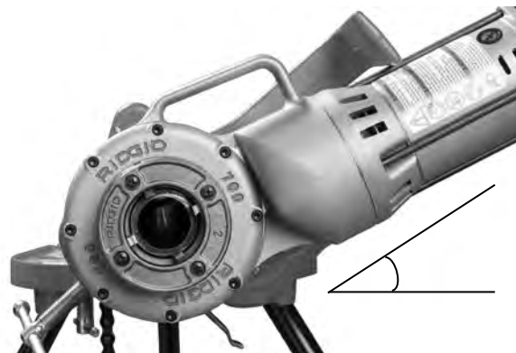
Figure 6 – Bras de support positionné avec système d'entraînement N° 700 légèrement incliné
