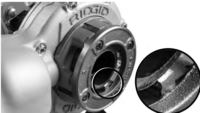
Figura 10 – El extremo del tubo está al ras con el borde de las terrajas
